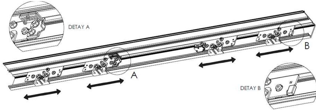
6. Elektronik kilidi, 3. adımda belirtilen bağlantı elemanlarını da kullanarak şekildeki gibi montajlayın.
