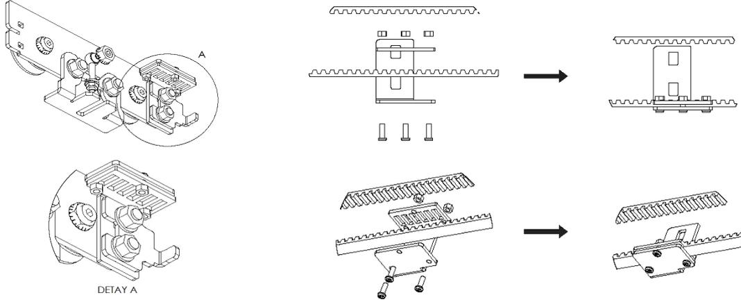
8.Motoru, kontrol ünitesini, trafoyu ve kayış gerdirme setini 3. adımda belirtilen bağlantı elemanlarını da kullanarak şekildeki gibi montajlayın.
